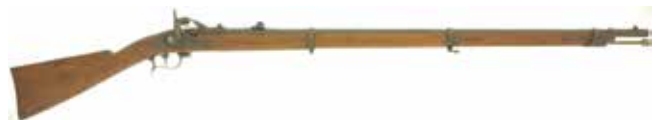
56671 CHF 330.- 277498 Einzelladerbüchse, Infanteriegewehr 1863/67, Kal. 10.4mmRF. LL 920mm, TL 1380mm, aptiert nach Milbank-Amsler, Quadrantvisier einstellbar bis 800 Schritte, Blockkorn. Nussholzschäftung. Eiserne Garnitur, Putzstock. #368 ANT Zustand 2
