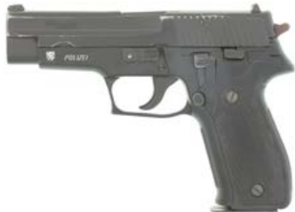
21888 CHF 550.- 265946 Pistole, SIG-Sauer P226, Kantonspolizei Thurgau, Kal. 9 mmP. LL 108 mm, schwarz eloxiertes Leichtmetallgriffstück, Schlitten Stahl, brüniert. DA-Abzug, Abspannhebel, Kimme und Korn seitlich eingeschlaufft. Griffstück vorne links Lasergravur Wappen vom Kt. TG und „Polizei“. DE und CH-Beschuss, schwarze Kunststoffgriffschalen mit Fischhautmuster. #U160214 WES Zustand 2
